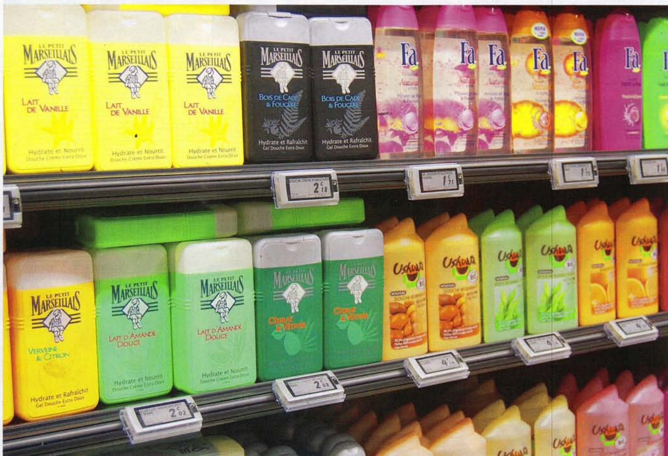
Etiquetas eletrônicas de prateleira, desenvolvidas pela Pricer e comercializadas pela Seal, agilizam a precificação
